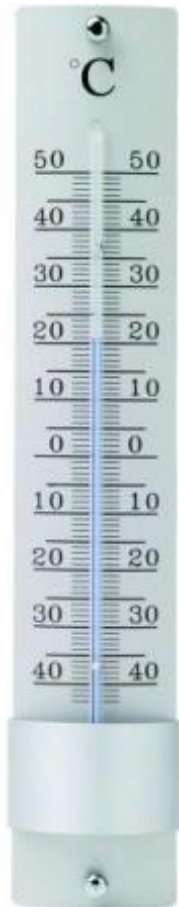
Folyadékos hőmérő (pontos, megbízható, törékeny)
